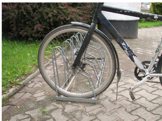
Rys. 19. Zły model stojaka (ul. Dąbrowszczaków)
