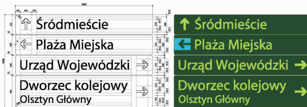
Moduł 3. Znaki duże na drogach dwujezdniowych o V > 60 \text{ km/h} - wys. liter dużych i cyfr 210mm
