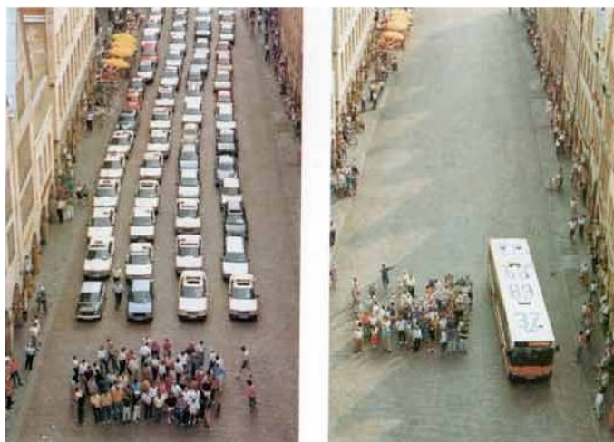
Rysunek 16-41 Porównanie ilości pojazdów potrzebnych do przewiezienia 60 osób (źródło: Muenster Planning Office)
