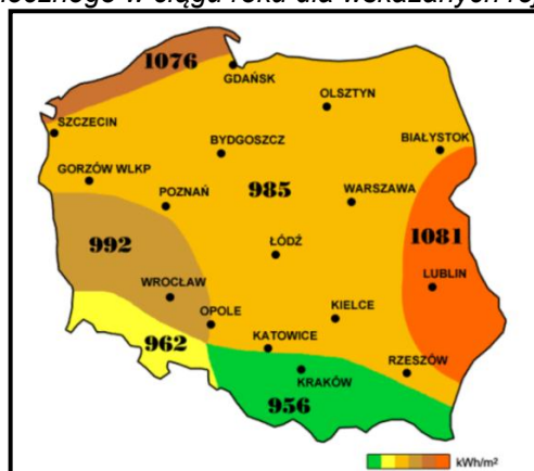
Rycina 10 Rejonizacja średniorocznych sum promieniowania słonecznego całkowitego padającego na jednostkę powierzchni poziomej w kWh/m 2 /rok. Liczby wskazują całkowite zasoby energii promieniowania słonecznego w ciągu roku dla wskazanych rejonów kraju
