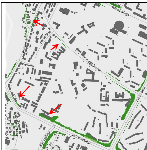
Ryc. 6. Hałas drogowy dla pory dnia . Kolor zielony oznacza przekroczenia do 5 dB. Strzałkami wskazano obiekty zagrożone hałasem - budynek LOVI, bloki przy ul. Niepodległości, bloki przy ul. Kościuszki 21 - mat. poglądowy
